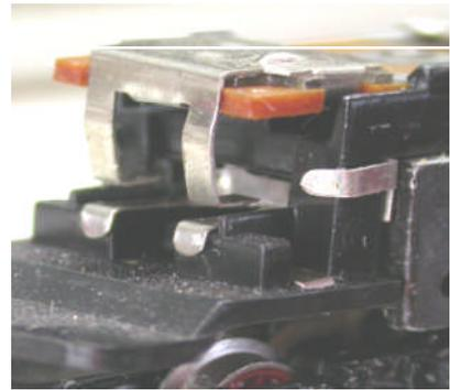
Bild 2: Korrekter Sitz der Kontaktbleche
